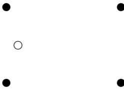
Die Menge der schwarzen Punkte und die Menge des weissen Punktes nicht durch eine Gerade streng trennbar. Obwohl alle zwei schwarzen Punkte und ein weisser Punkt durch eine Gerade streng trennbar sind.
